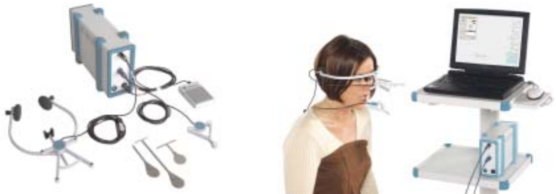
Abb. 1_Instrumente und Ausgangsstellung zur Ultraschallmessung der Kieferbewegungen
